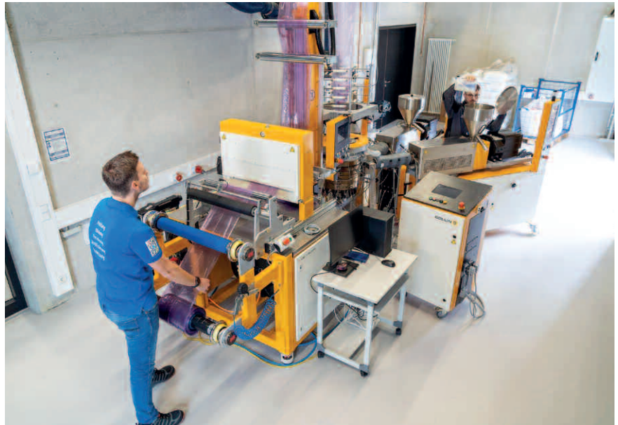
Das Kunststoff-Zentrum SKZ verfügt seit Sommer 2023 über eine eigene Blasfolienanlage (Foto: SKZ)
