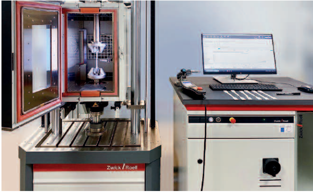
Die elektrodynamische Prüfmaschine LTM 10 ist mit einer Temperiereinrichtung ausgestattet, die sowohl für eine kräftige Luftströmung als auch für exaktes Einhalten der Prüftemperatur sorgt
