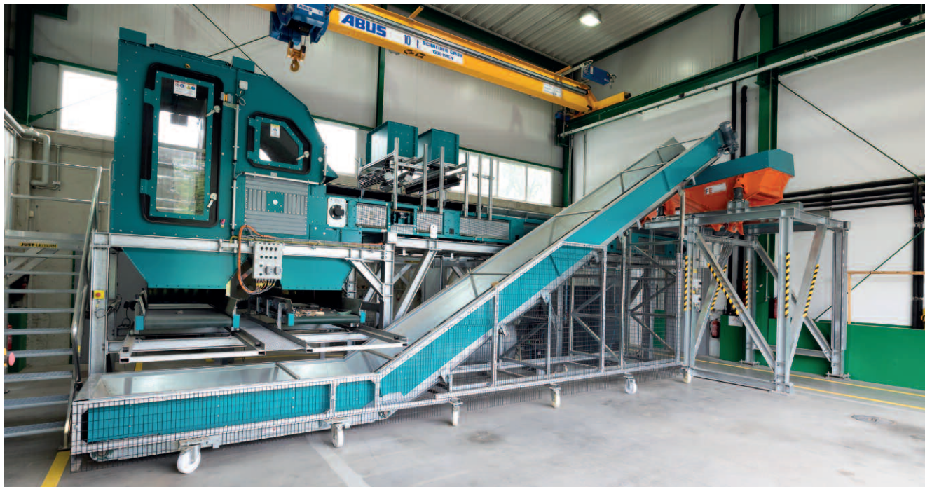
Sensorbasierte Sortieranlage im Digital Waste Research Lab in St. Michael in der Obersteiermark (©AVAW Leoben)
