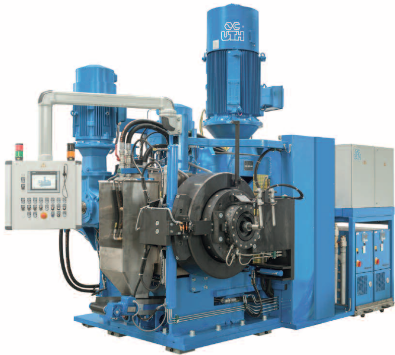
Setzt neue Maßstäbe: roll-ex® 1000 TRF mit Durchsätzen von bis zu 10.000 kg/h
