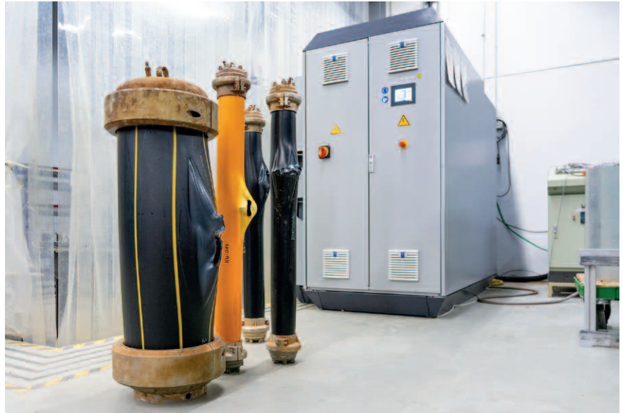
Geprüfte Rohre vor dem neuen Großrohr-Berstprüfgerät (Foto: Luca Hoffmannbeck)
